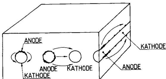
Fig. 6 Verschiedene Korrosionszellen. Der galvanische Strom fliesst in Richtung der Pfeile.
