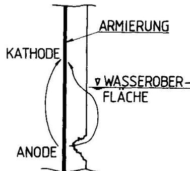
Fig. 7 Galvanische Korrosion unter der Wasseroberfläche.
