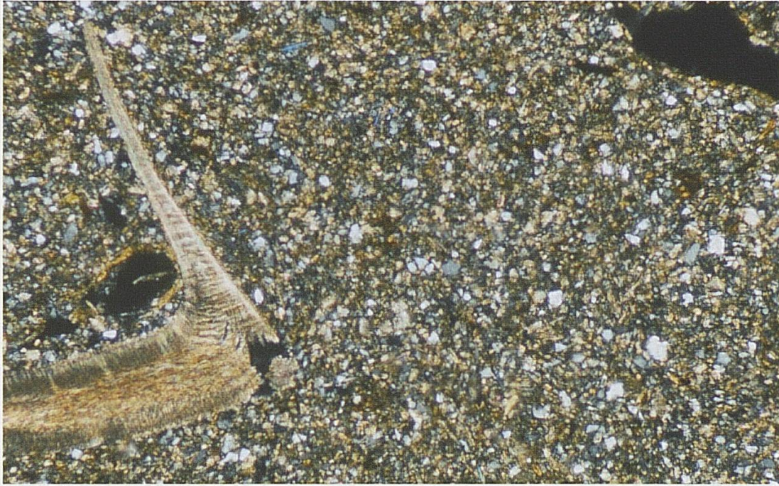
Fig. 7: Vue au microscope des lœss du Pléniglaciaire supérieur (unité E6, Alle - Noir Bois). Ces dépôts sont formés de grains bien triés de quartz, mica et calcite d'une taille de 20 microns. A gauche, une coquille de mollusque. Lumière polarisée, hauteur réelle: 1,5 mm (photo M. Guélat).
