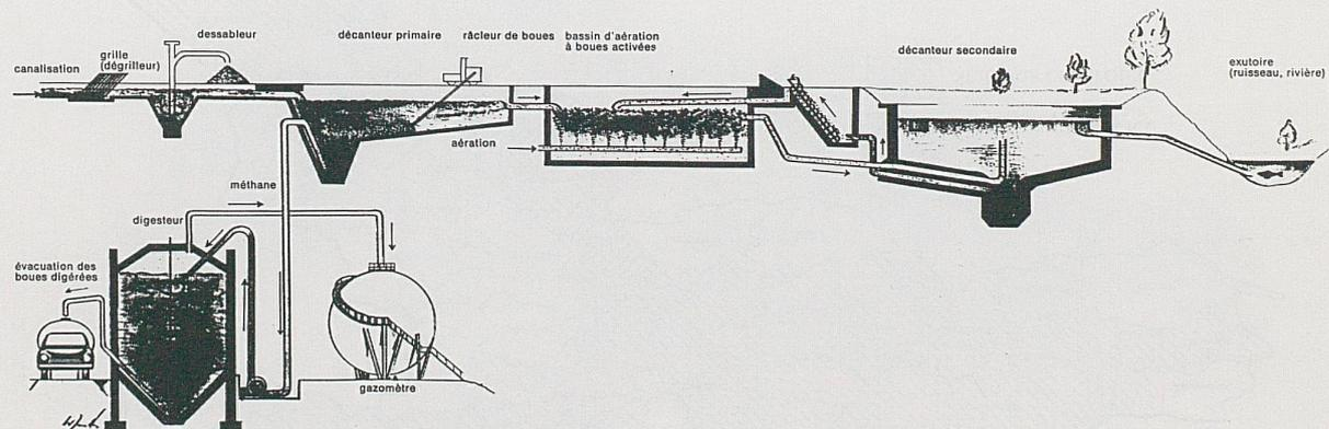
**Schéma type d'une station d'épuration mécano-biologique
