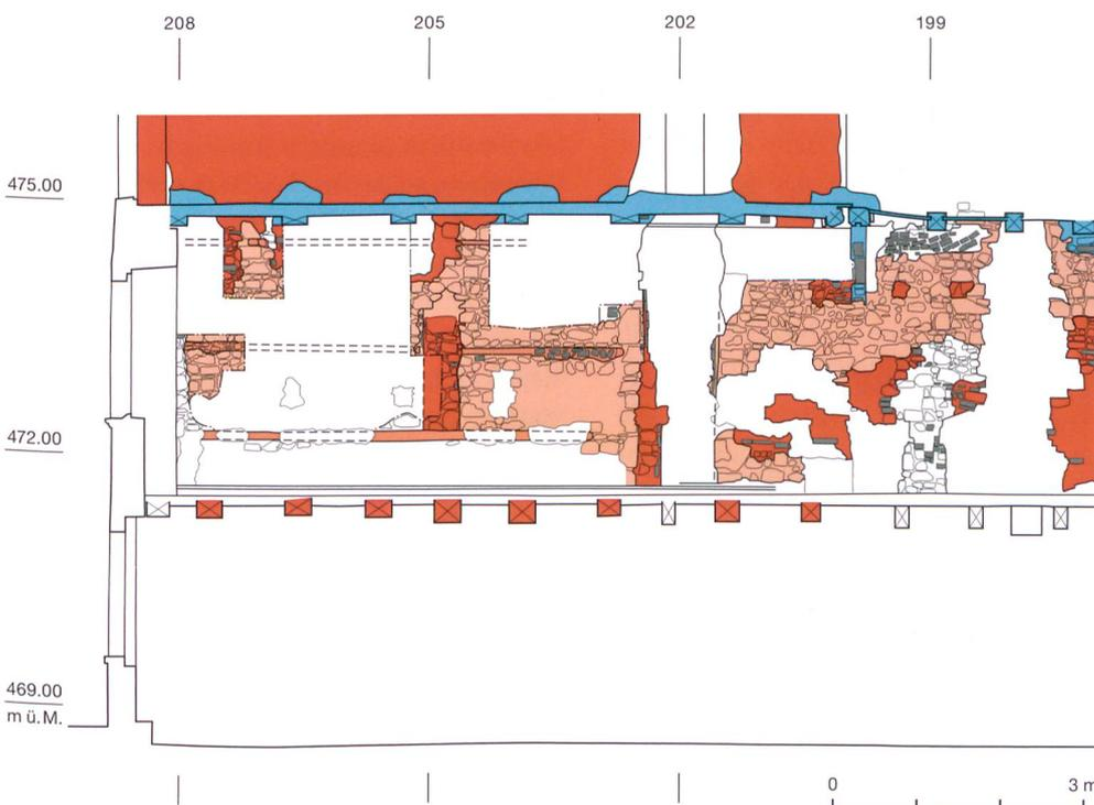
Abb. 5: Wiedlisbach, Städtli 21. Östliche Brandwand zu Parzelle Städtli 19 im ersten Obergeschoss. Deutlich zeichnen sich die Balkenspuren einer gassenseitigen Holzkammer ab, die wahrscheinlich 1423 durch den Stadtbrand zerstört wurde. M. 1:100.
